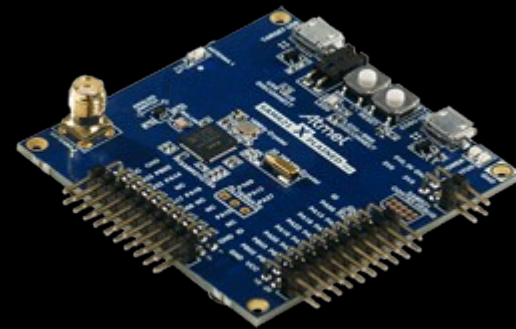
SAM R21 Xplained Pro 32 bit ARM Cortex-M0+ 2.4 GHz radio
