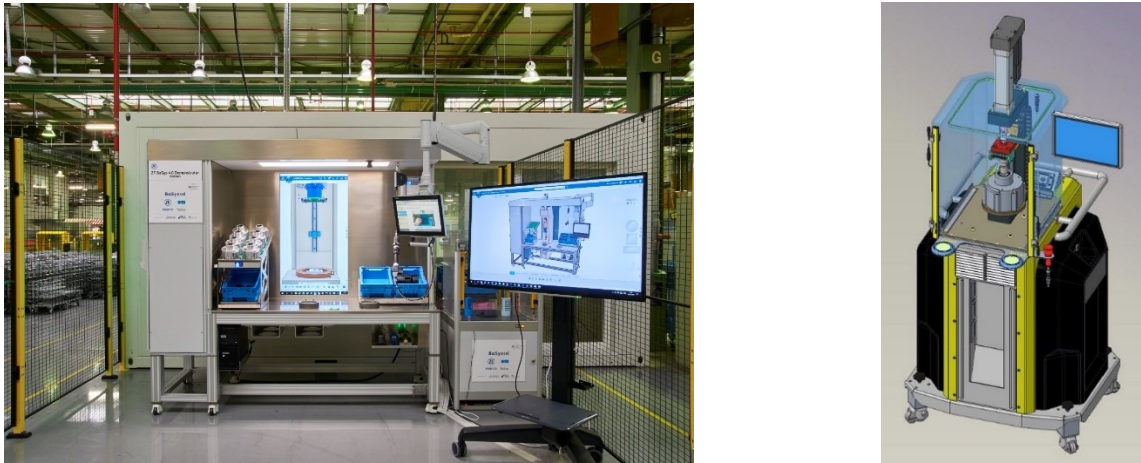
Abb. 2: Ergänzung der ZF Station mit einem Bosch Rexroth Modul (rechtes Bild)
